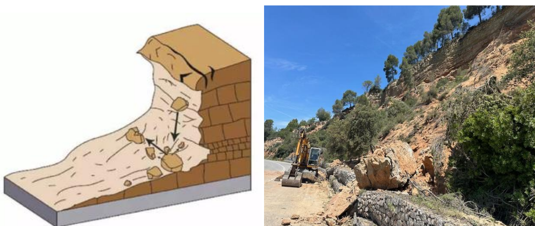
Figura 2. Esquema gràfic de despreniment de roques
