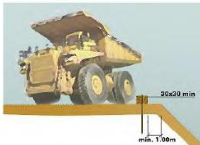
Esquema límit retrocés en abocament de terres
