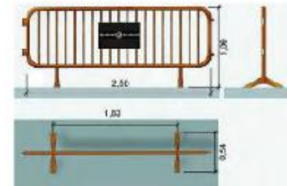
Valla provisional d'obra
