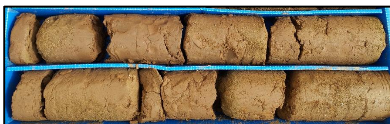
Exemple dels materials argilosos del tram central de la capa B.
