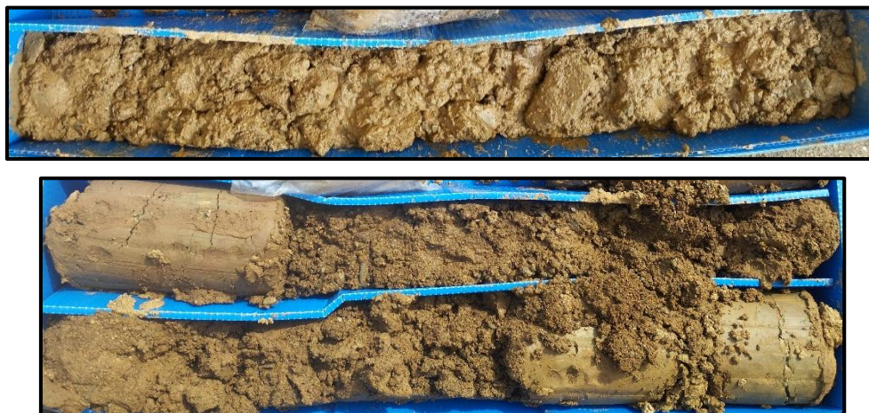
Exemple dels materials granulars (sorres i graves) que s'intercalen entre trams més cohesius dins de la capa D.
