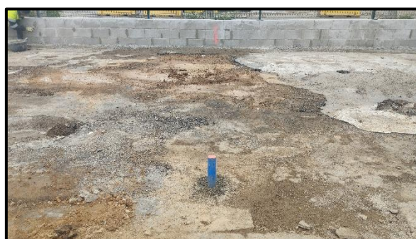
Detall dels piezòmetres instal·lats en el solar d'estudi, en l'emplaçament dels sondeigs S-2, S-3, S-4 i S-7
