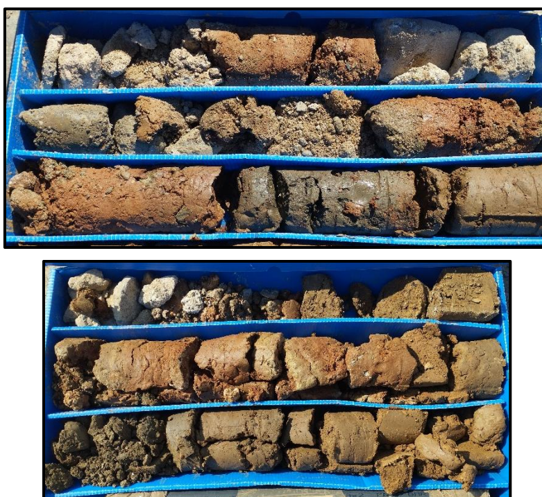
Diferents exemples de l'aspecte dels materials de rebliment de la capa R, amb una barreja d'argiles i sorres, amb algunes restes antròpiques.
