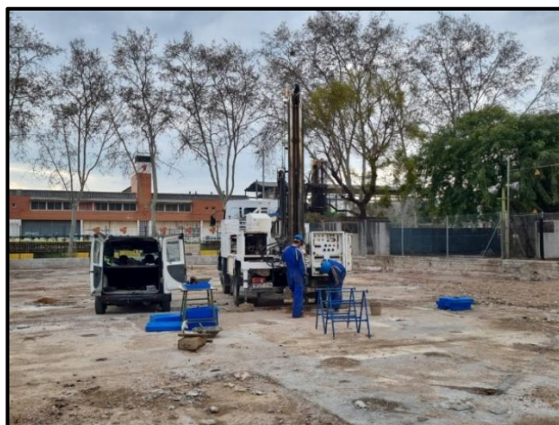
Diferents vistes del solar d'estudi amb la maquinaria de sondeigs emplaçada. D'esquerra a dreta i de dalt a baix, situació del sondeig S-1, l'assaig de penetració P-3 associat, i els sondeigs S-2, S-3, S-4 i S-5.
