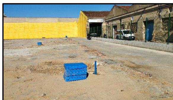
Detall dels piezòmetres instal·lats en el solar d'estudi, en l'emplaçament dels sondeigs S-2, S-3, S-4 i S-7
