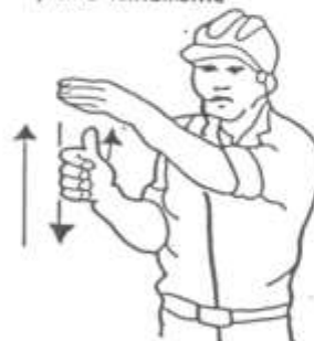
4 Levantar el aguilón o pluma lentamente
