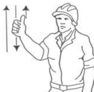
4 Levantar el aguilón o pluma lentamente
