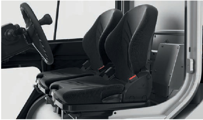
Comoditat de treball única a la seva classe amb el seient amb suspensió pneumàtica MSG 75 opcional: Suspensió superior en xassis esmorteït i amb molls
