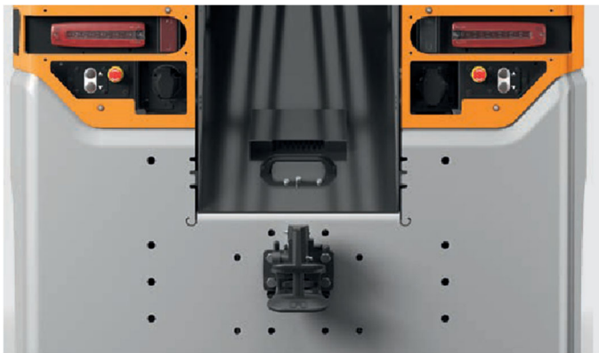
Els dispositius de marxa enrere a la part posterior garanteixen un acoblament i desacoblament segurs i eficients
