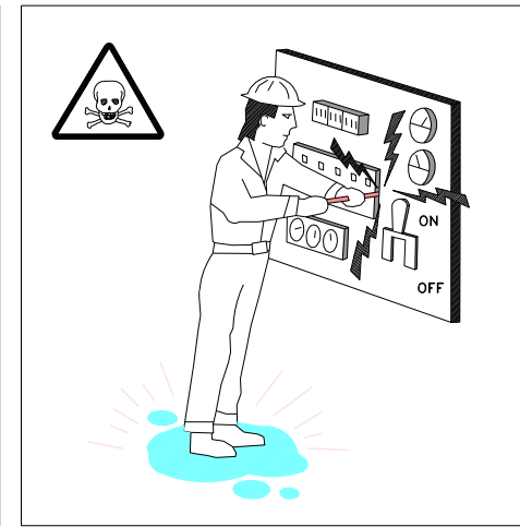
REPARACIÓ D'EQUIPS SOTA TENSIÓ
