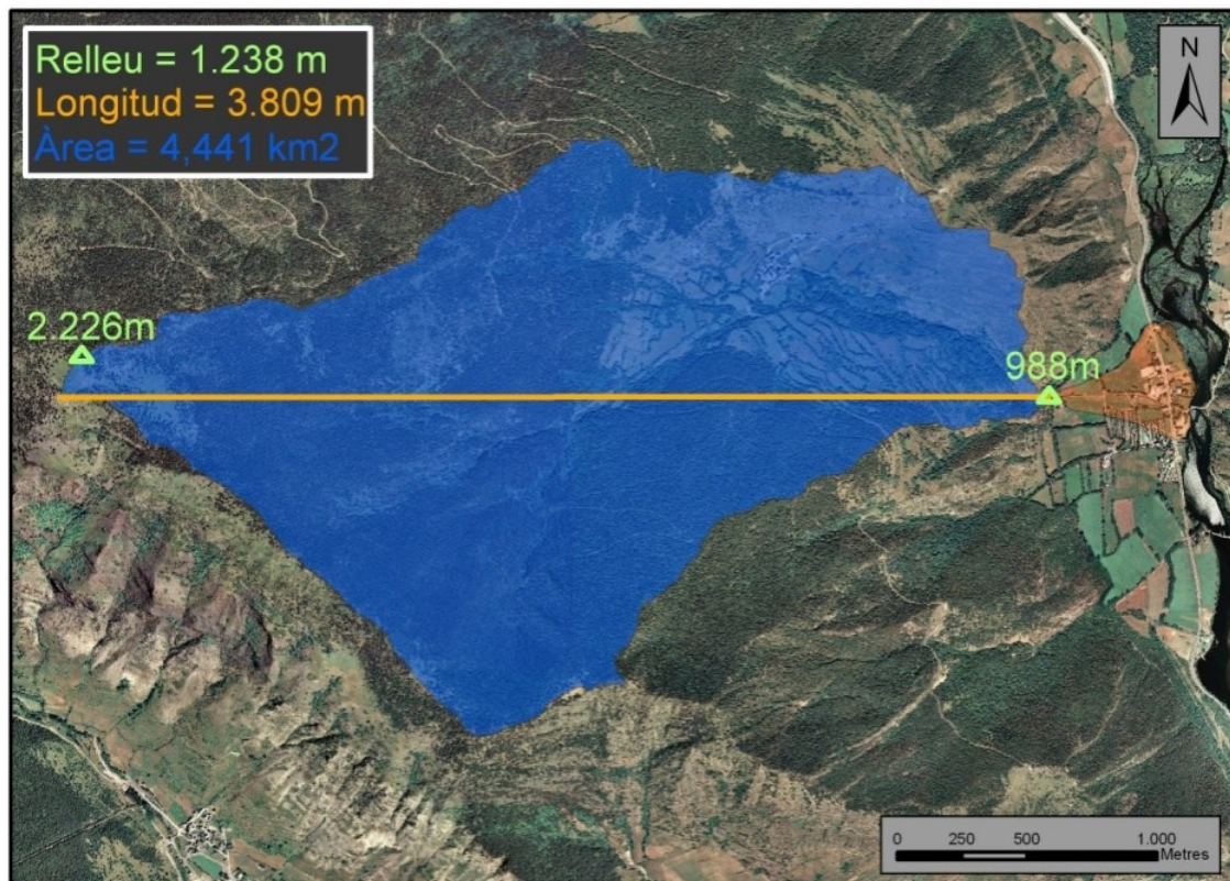
Figura 20. Paràmetres morfomètrics: en blau l'àrea de la conca (en km 2 ); en taronja la longitud de la conca i en verd el relleu de la conca (en km).
