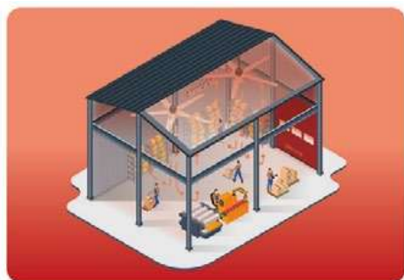
El diferencial de temperatura se minimiza y el aire se mezcla
