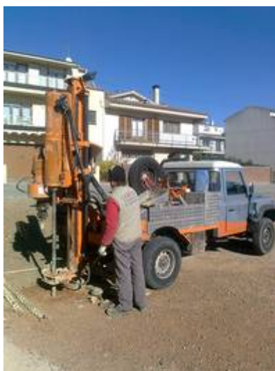
Vistes dels tres sondeigs realitzats al solar objecte d'estudi, S-2 del tipus Rotació helicoidal i P-1 i P-3 del tipus DPSH
