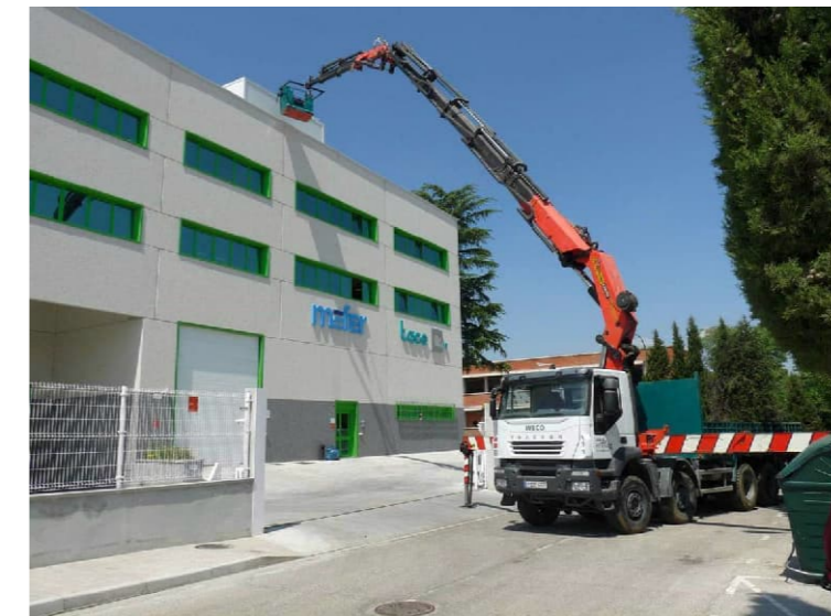
Figura 10. Exemple de mitjà auxiliar per a manteniment de coberta recomanable.
