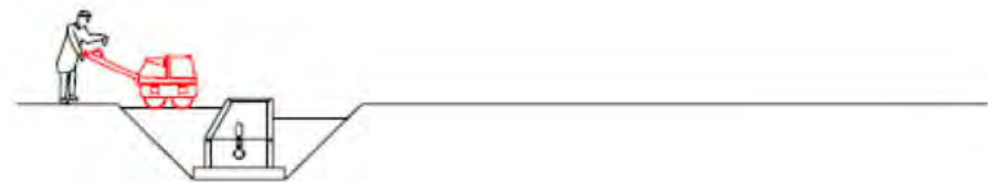
7. Compactació de terres al voltant del pou
