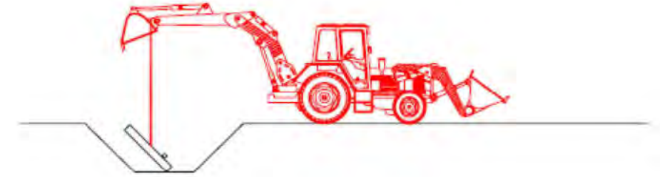
3. Col·locació de la base del pou
