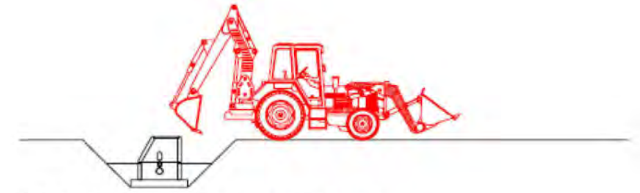
6. Reblert del pou amb retro-excavadora en tongades
