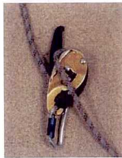
Dispositivo Descensor según EN 341
