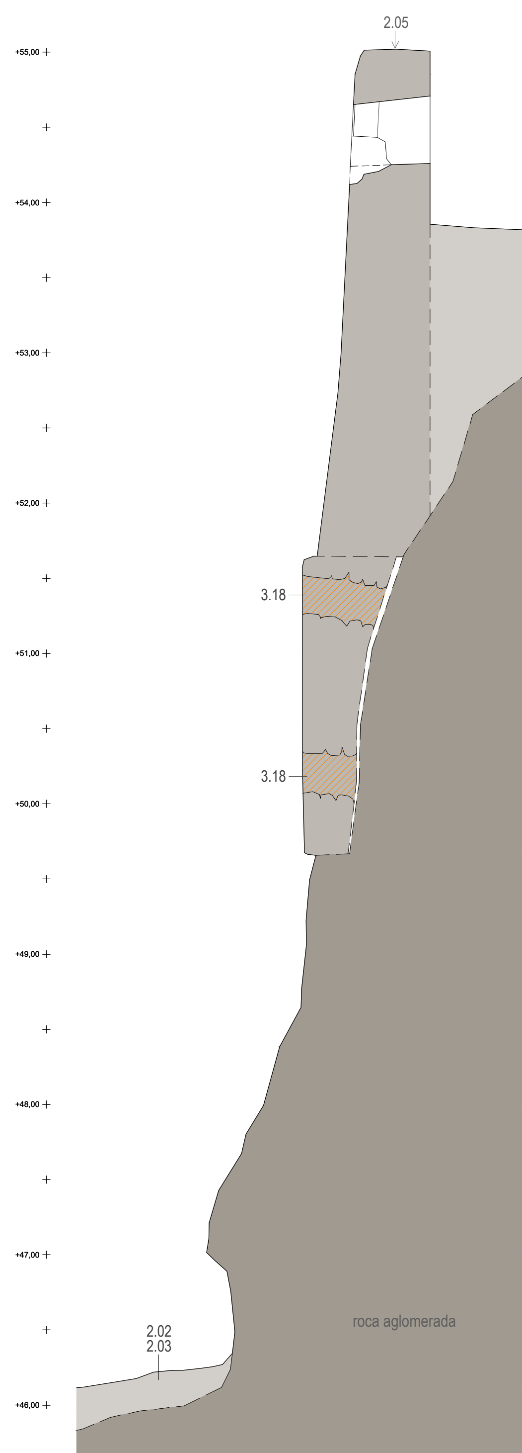
ESTAT ACTUAL SECCIÓ TRANSVERSAL S1 - Escala: 1/25
