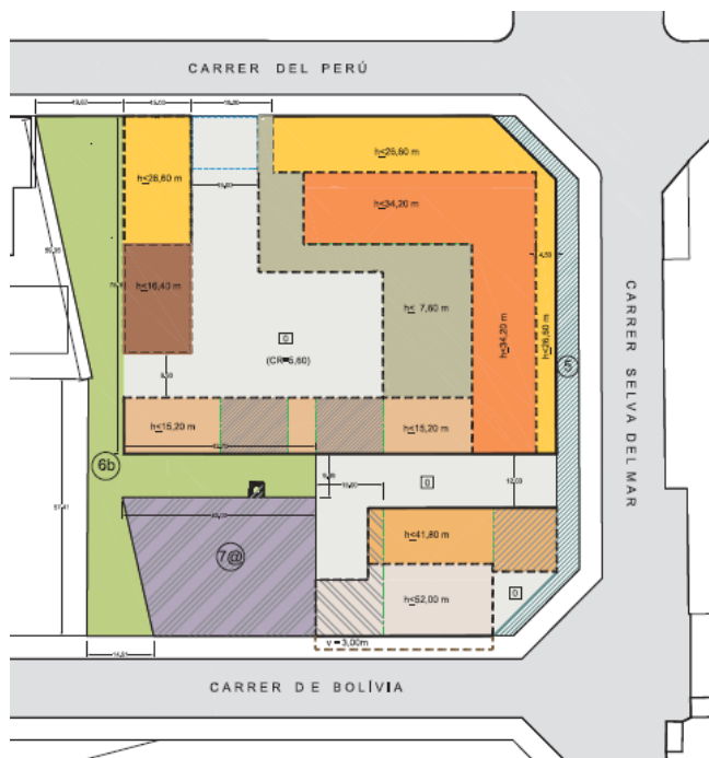
Perímetres reguladors. PMU de les parcel·les dels carreres Perú i Bolívia amb front al carrer Selva de Mar
