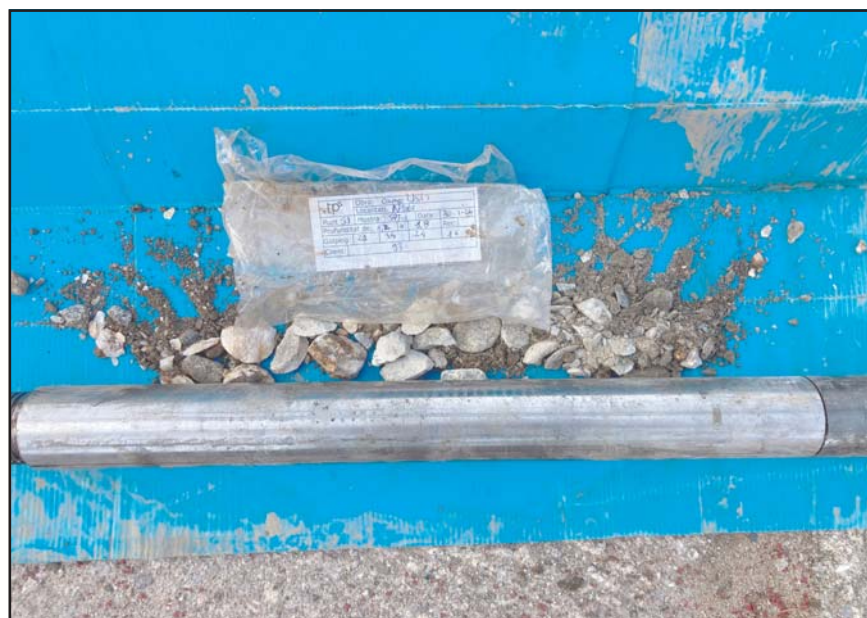
Fotografia 3. Material recuperat en l'assaig SPT-1.
