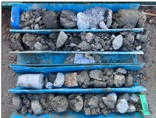
Fotografia 5 i Fotografia 6. Detall dels materials del segon nivell recuperat del sondeig a rotació realitzat.
