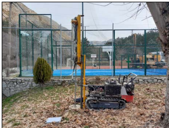
Fotografia 3. Vista de la màquina utilitzada en l'assaig de penetració dinàmica P-1.
