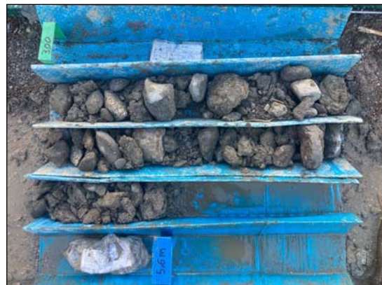
Fotografia 5 i Fotografia 6. Detall dels materials del segon nivell recuperat del sondeig a rotació realitzat.
