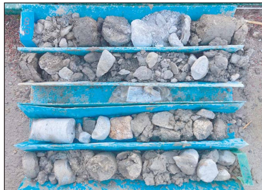
Fotografia 2. Material recuperat en el sondeig S-1 entre les cotes de 0.00 a -3.00 metres de profunditat.
