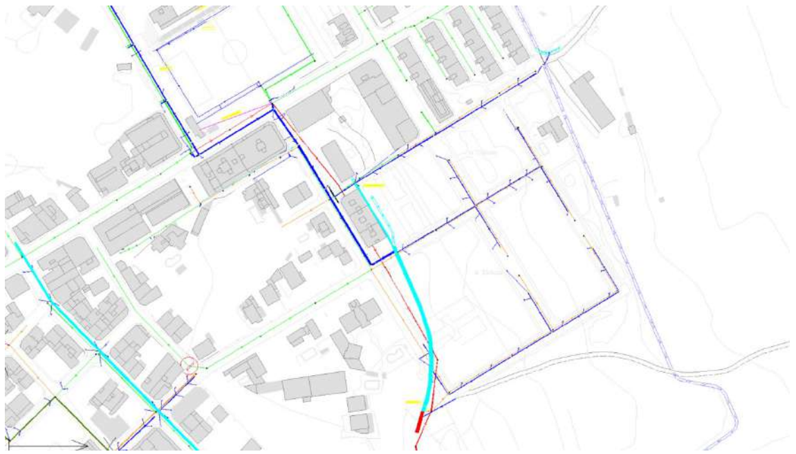
Imatge 3. Ampliació xarxa de sanejament zona del carrer Barranquet Color blau+cyan correspon als pluvials i verd, vermell i taronja als residuals.
