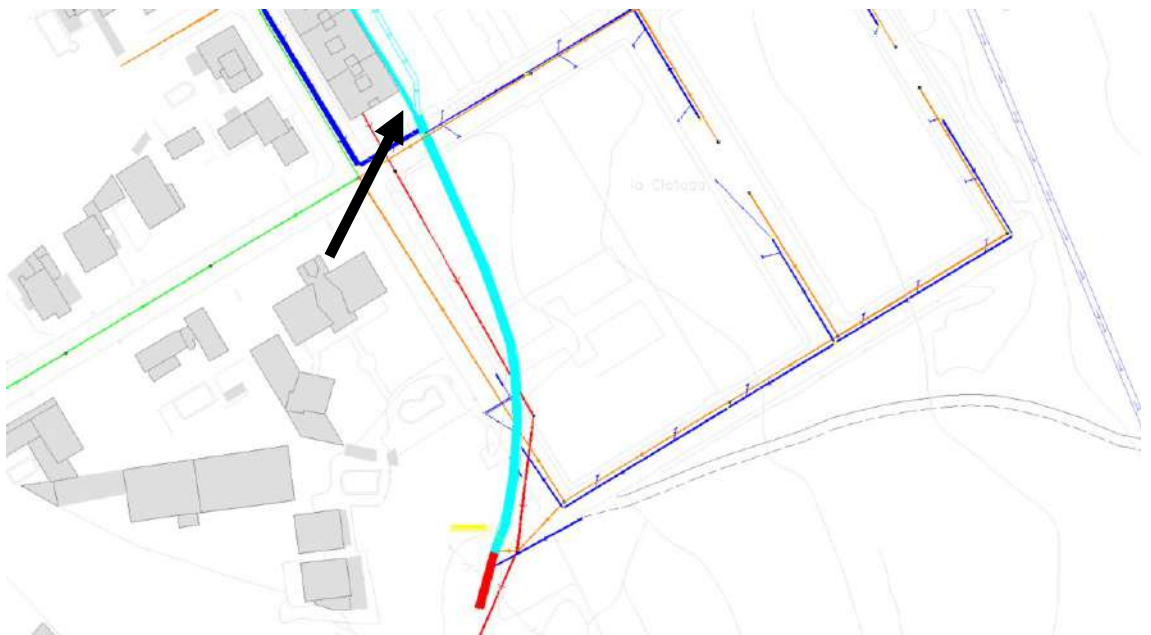
Imatges 4. Xarxa sanejament carrer Barranquet. Color blau+cyan correspon als pluvials i verd, vermell i taronja als residuals. En color vermell i amplada gran es mostra el col·lector antic del carrer Barranquet (afectat per la DANA). La fletxa indica la ubicació del mur de transició entre el col·lector rectangular (antic) i el nou col·lector circular (també afectat per la DANA).
