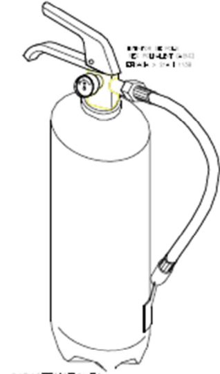
CARACTERÍSTIQUES: Extintor de pols ABC amb cilindre 135-1500 per a volum de 400 de capacitat cilíndric, líquida, performància passiva i cívica d'apagat d'extinció de 6 Kg. Capaç contra amb sòlids, líquids, gasos i cívica d'apagat d'extinció segons norma UNE-EN-23110, totalment muntat. Certificat per AENOR
