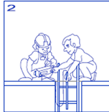
2) Neteja, mesurament i evacuació de l'ambient interior, per personal qualificat, per a determinar la seva perillositat.
