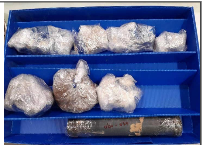
Fotografía nº 13 Muestras inalteradas tomadas por hinca en PVC y en bloque.
