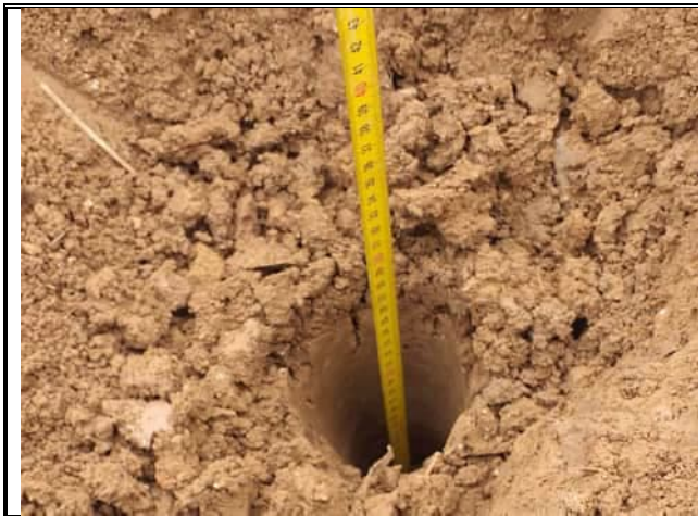
Fotografía nº 13 Punto de muestreo de la inalterada por hinca MI-1.
