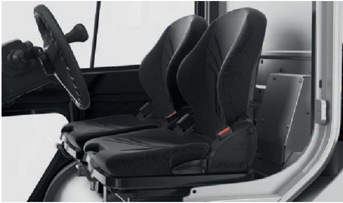
Comoditat de treball única a la seva classe amb el seient amb suspensió pneumàtica MSG 75 opcional: Suspensió superior en xassís esmorteït i amb molls
