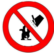
PROHIBIT APAGAR AMB AIGUA
