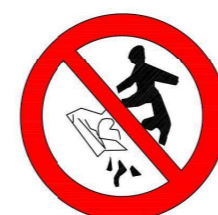
PROHIBIT TREPITJAR SÒL NO SEGUR
