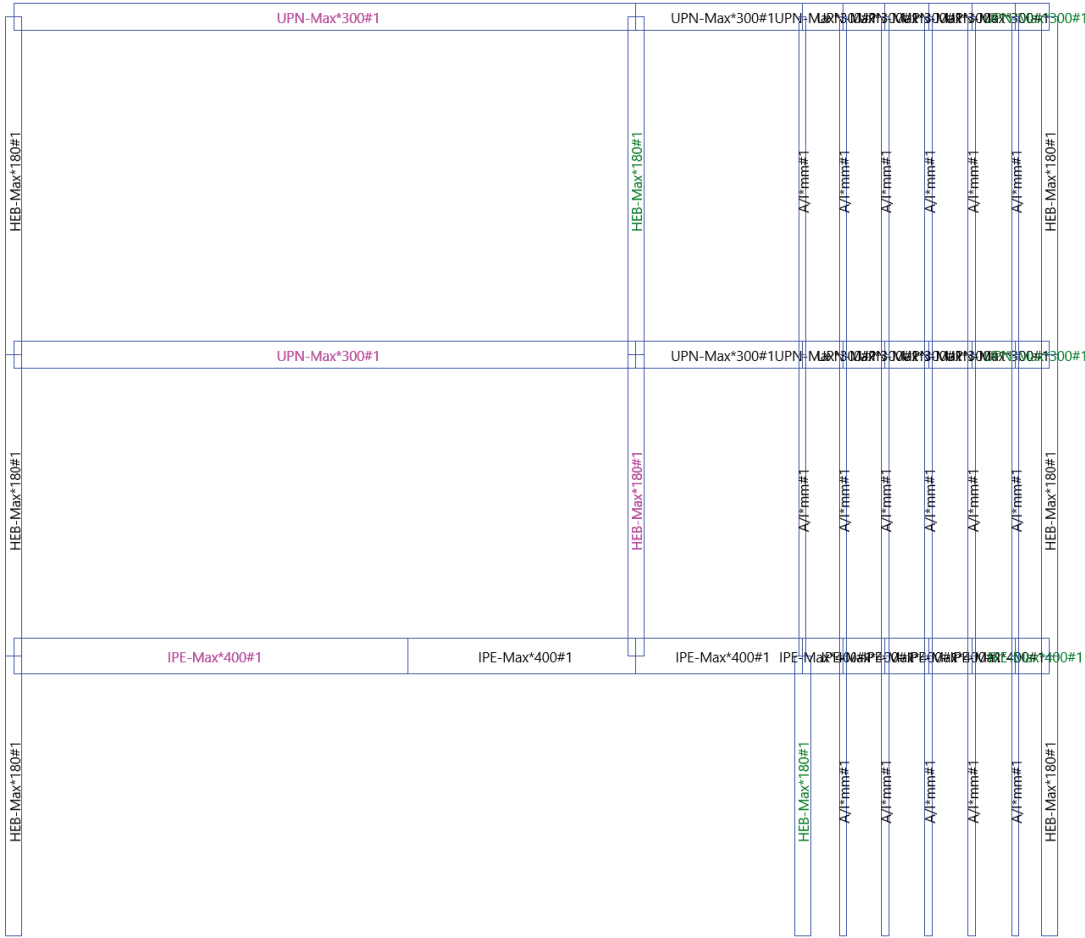
Dimensionat perfils metàl·lics
