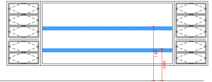
3 1 UT. - FRANJA SUPERIOR H. 160 CM - FRANJA INFERIOR H. 95 CM EX 4 3 UT. A LA VIDRIERA ZONES CIRCULACIÓ (P. BAIXA I P.PRIMERA): - DUES FRANGES AMPLADA 10 CM
