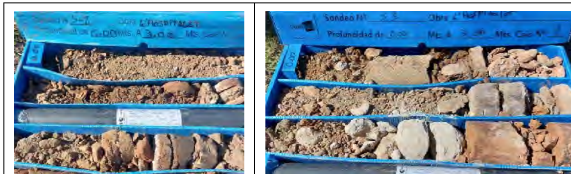
Aspecte del reblert extret dels sondeigs S-2 i S-3
