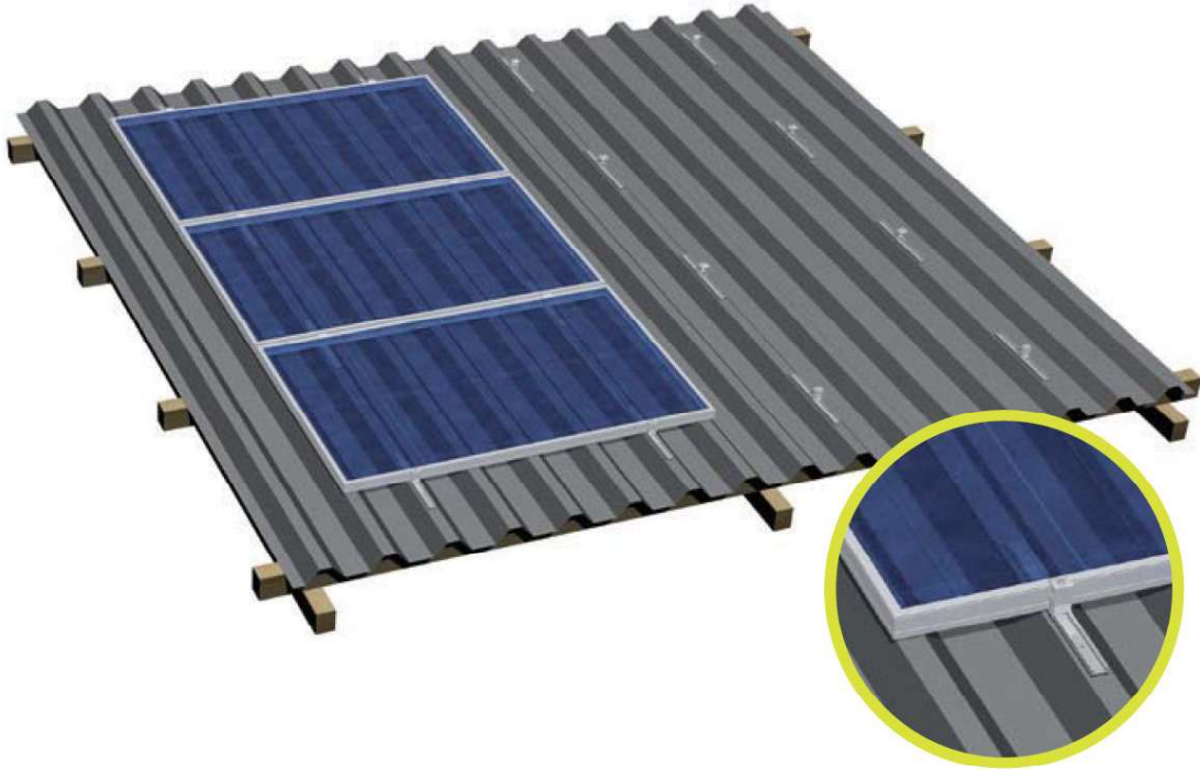
Fig. 6.3. Sistema de subjecció coplanar S-Flex.
