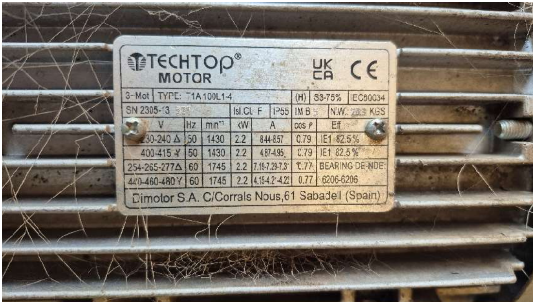
Figura 7. Motor-reductor del cargol transportador a instal·lar
