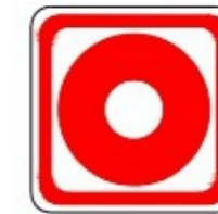
PULSADOR DE ALARMA
