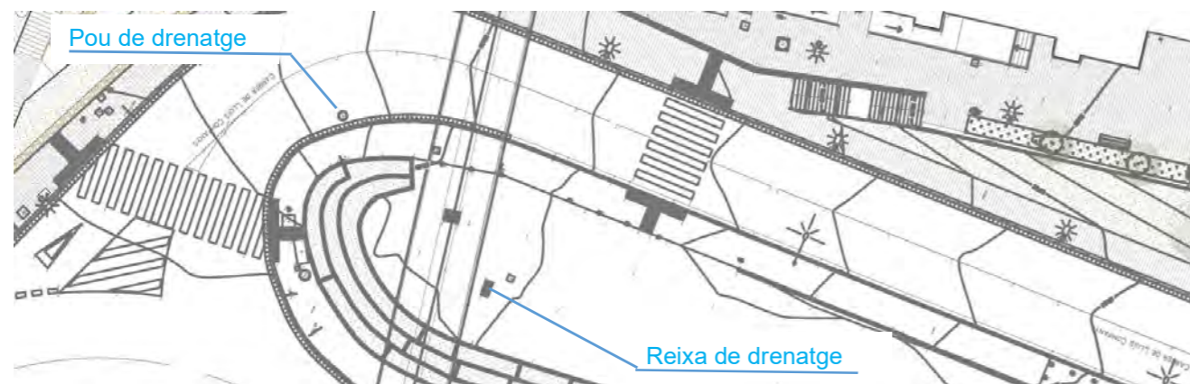
Elements de drenatge àmbit carrer Lluís Companys
