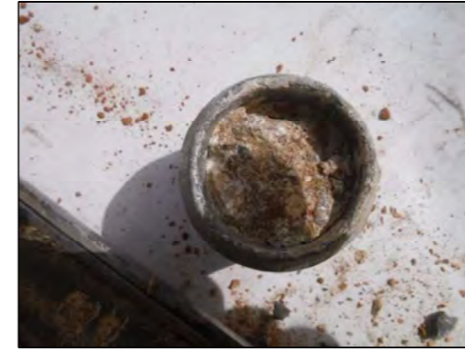
Foto 7: Sondeig S-2, SPT a 3,9 metres.
