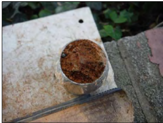
Foto 3: Sondeig S-1, boca SPT a 3,4 metres.
