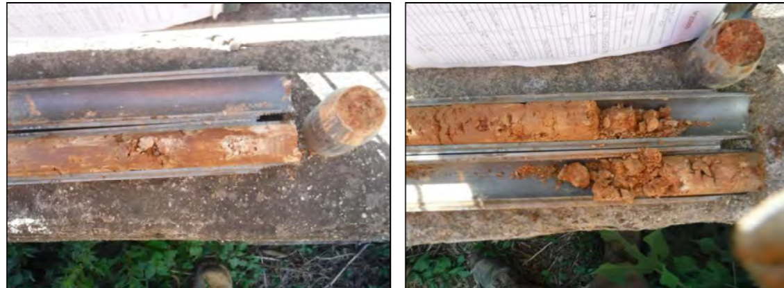
Mostres dels materials de la capa A, als assaigs SPT.
