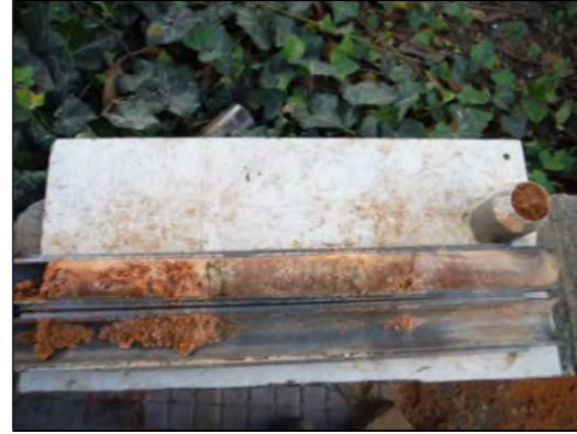
Foto 2: Sondeig S-1, SPT a 2,8 metres.
