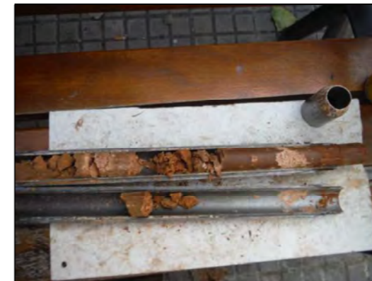
Foto 9: Sondeig S-3, SPT a 1,3 metres.
