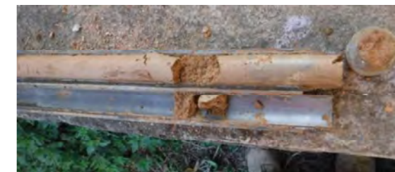
Mostres dels materials de la capa B, als assaigs SPT.
