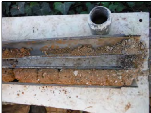
Foto 5: Sondeig S-1, SPT a 8,3 metres.
