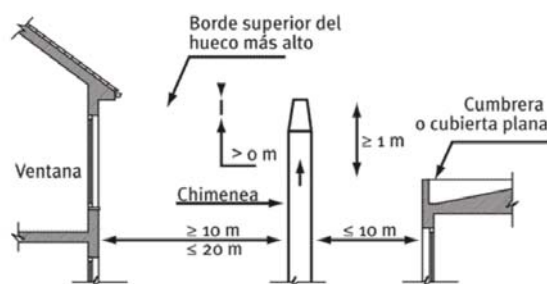
Figura 32: Elevación mínima de los remates de las chimeneas sobre edificios colindantes (UNE 123001)
