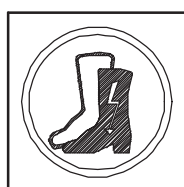
PROTECCION OBLIGATORIA DE LOS PIES (BOTAS DIELECTRICAS)
