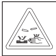
RIESGO DE CORROSION SUSTANCIAS CORROSIVAS
