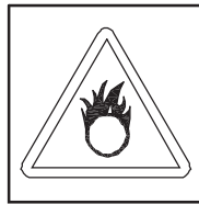
¡PELIGRO! MATERIAL COMBURENTE
