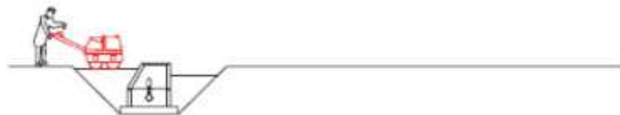
7. Compactació de terres al voltant del pou
