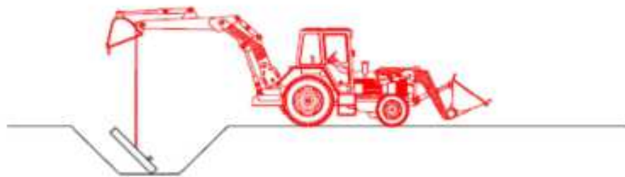
3. Col·locació de la base del pou
