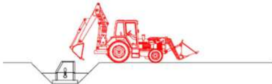
6. Reblert del pou amb retro-excavadora en tongades
