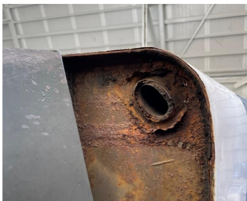
Figura 10: zona de corrosió a la canonada de drenatge i a les canonades
