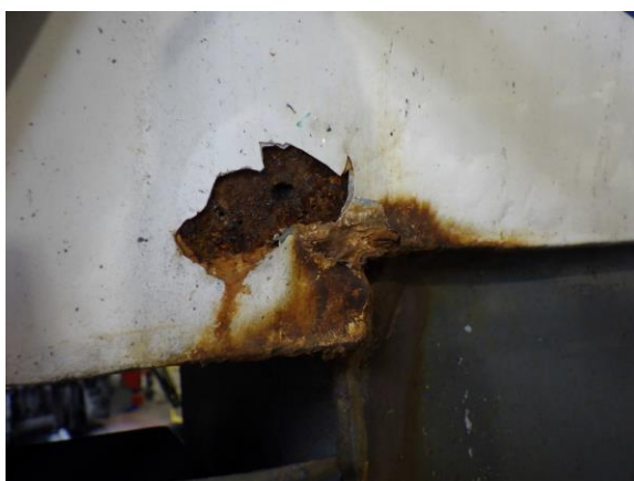
Pos. 06: corrosió a la part davantera del vehicle.
