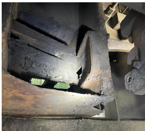
Figura 12: zona de corrosió a les canonades i al para-xocs davanter
