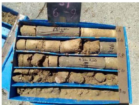
Sondeig S01, testimonis i mostres. 6.00-9.00 m.
