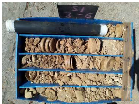
Sondeig S01, testimonis i mostres. 3.00-6.00 m.
