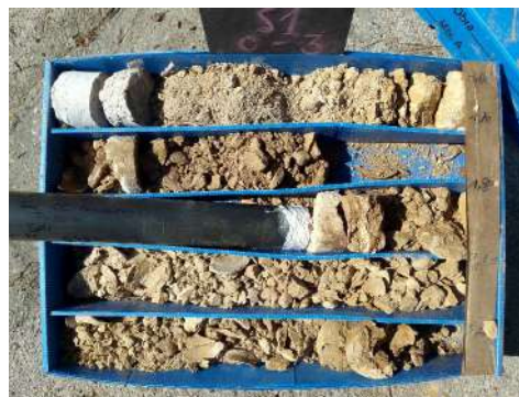
Sondeig S01, testimonis i mostres. 0.00-3.00 m.
