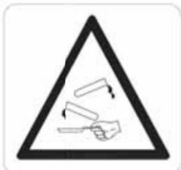
RISC DE CORROSIÓ
