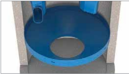
Figura 4. El Downstream Defender® Select con opciones para retención mejorada de sedimentos e hidrocarburos ligeros (aceites y grasas).
