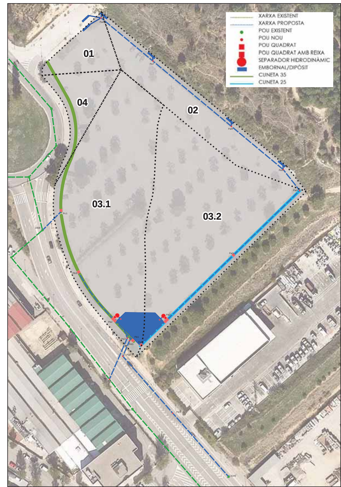
Figura 2. Conques de drenatge i elements de captació
