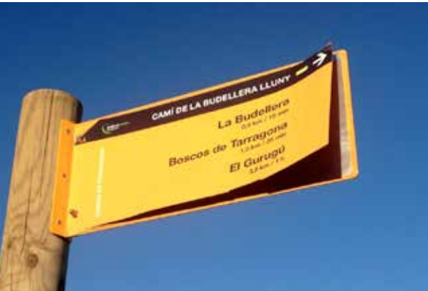
Vinil desenganxat per la mala adherència de la pintura a la xapa
