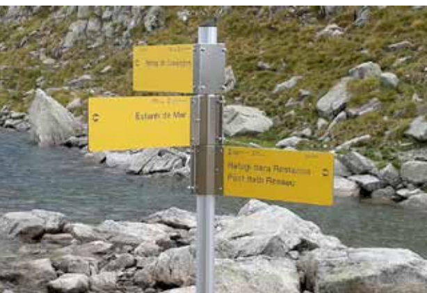
L'experiència aranesa de senyalització en alta muntanya: senyals de fusta gravada, banderoles d'alumini amb vinil i banderoles de material fenòlic
