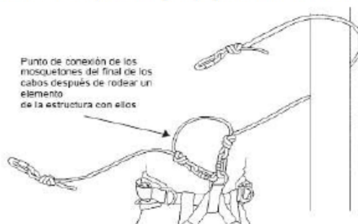
Figura 5 Forma de connexió de caps d'ancoratge en progressions horitzontals o a través d'estructures
