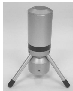
Figura 11 Detall de l'antena fixa actual del sistema ràdio ATO de L1.
