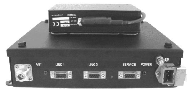
Figura 10 Detall de l'equip BS actual del sistema ràdio ATO de L1.
