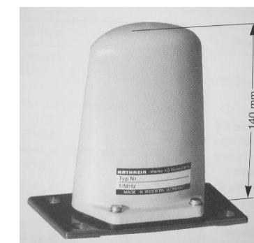
Figura 14 Detall de l'antena mòbil actual del sistema ràdio ATO de L1.
