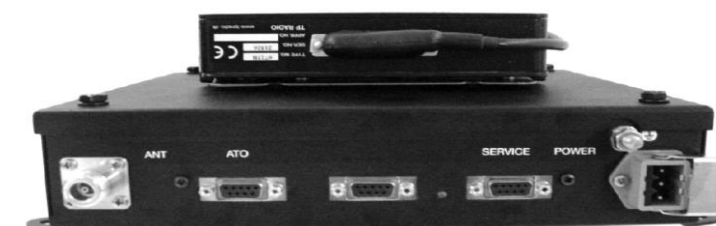
Figura 13 Detall de l'equip MS actual del sistema ràdio ATO de L1.
