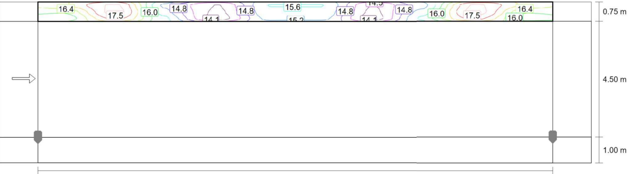
Valor de mantenimiento iluminancia horizontal [lx] (Líneas Isolux)
