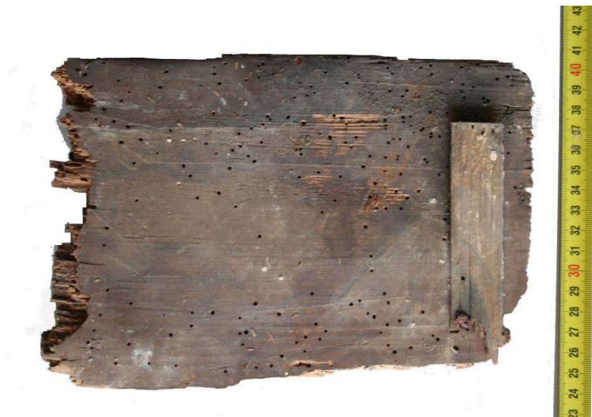
Imatge 8. Tauló amb tapajunts clavat
