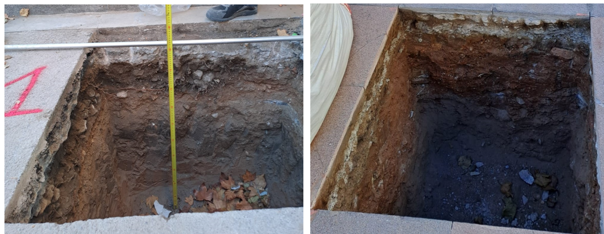
Fotografies de la cala 1 i la cala 2, amb terreny argilós sota el paviment.
