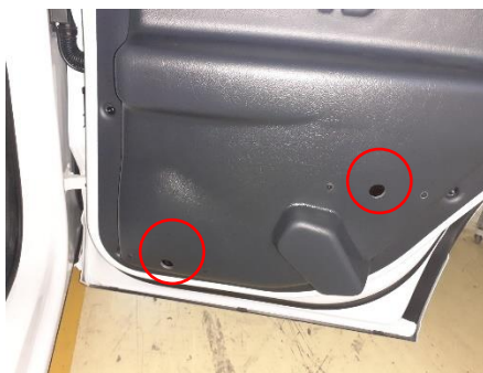
Sistema de barrera de raigs infrarojos, composta d'un mòdul transmissor i un mòdul receptor, ubicats a les portes.
