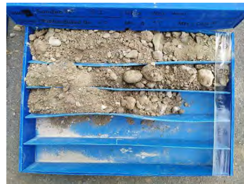
Fotografia 10. Caixa testimoni del sondeig S-2 de 6 a 9 metres.
