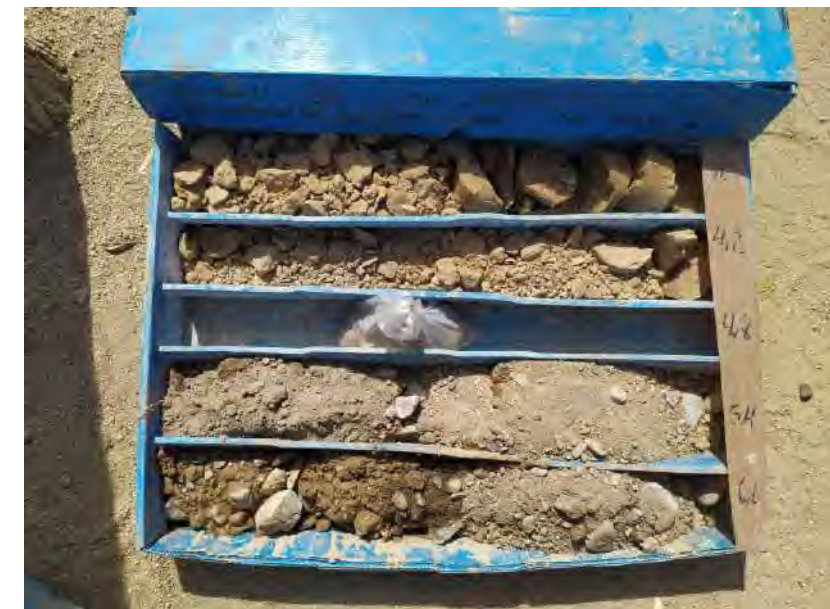
Fotografia 3. Caixa testimoni del sondeig S-1 de 3 a 6 metres.
