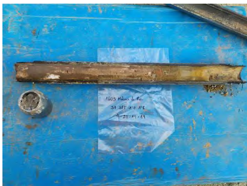
Fotografia 5. Assaig SPT a 1,2 metres al sondeig S-1.
