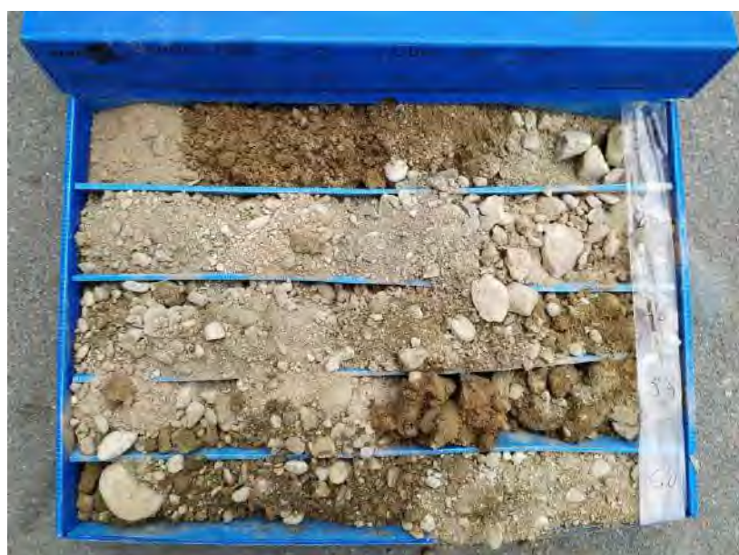
Fotografia 9. Caixa testimoni del sondeig S-2 de 3 a 6 metres.
