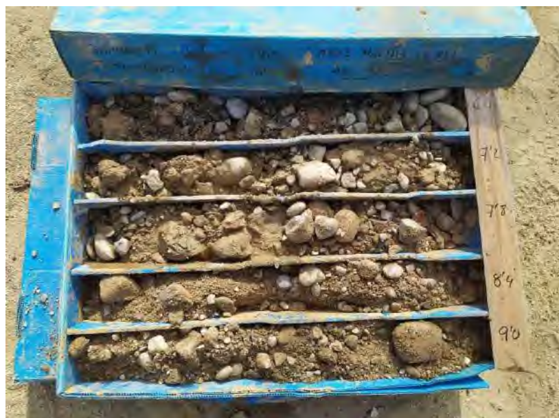
Fotografia 4. Caixa testimoni del sondeig S-1 de 6 a 9 metres.
