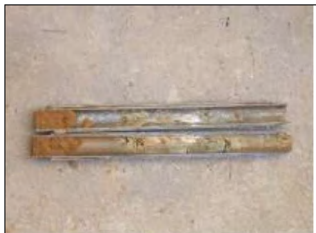
Figura 4. Assaig SPT amb el tub bipartit obert.
