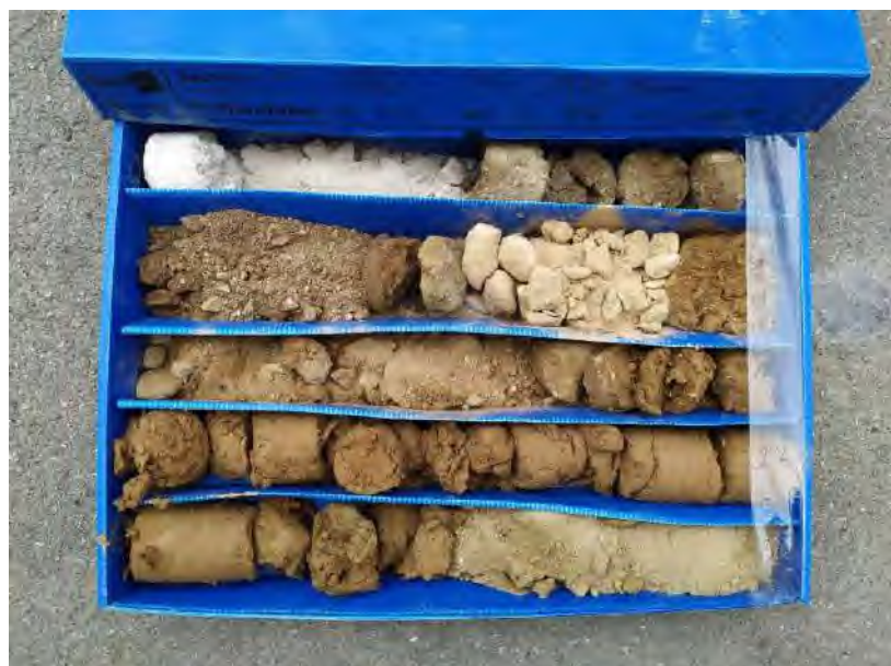
Fotografia 8. Caixa testimoni del sondeig S-2 de 0 a 3 metres.
