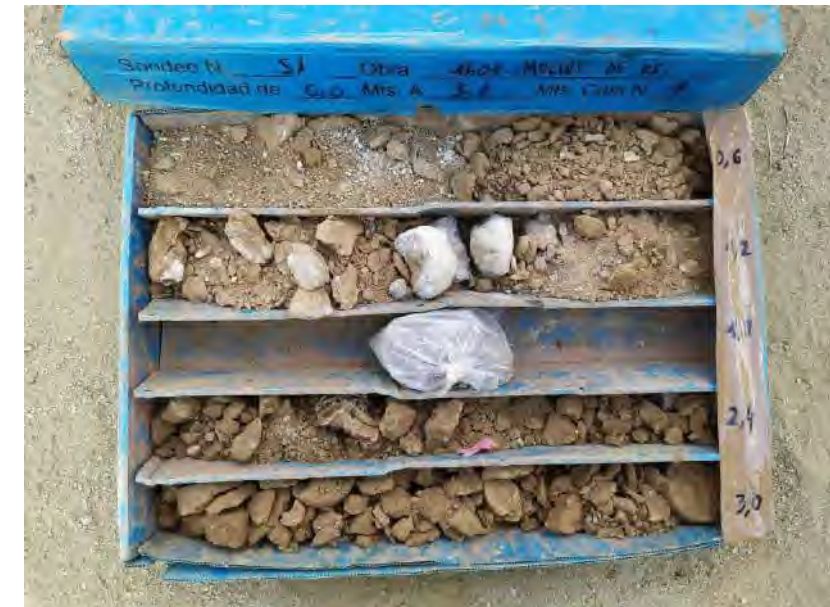
Fotografia 2. Caixa testimoni del sondeig S-1 de 0 a 3 metres.
