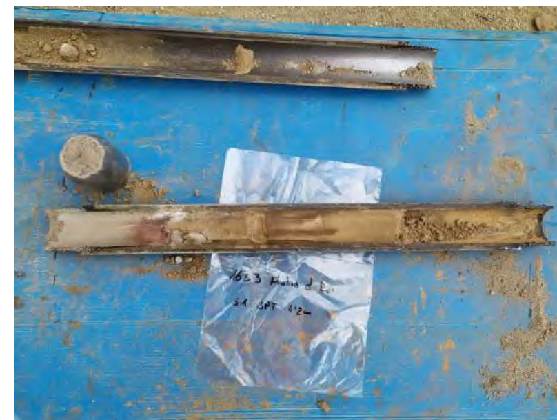
Fotografia 6. Assaig SPT a 4,2 metres al sondeig S-1.
