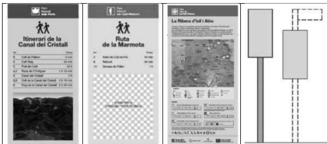
Figura 5 Exemple de senyals informatives de 450*900mm., i disposició sobre els suports de fusta. Font: Manual tècnic senyalització ENP
