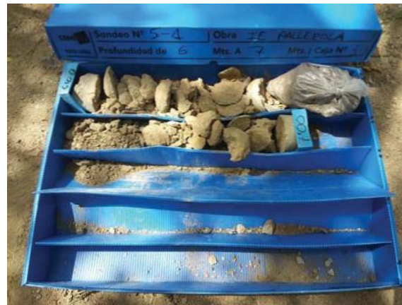
Sondeig S-01, Assaig SPT de 6,00 – 7,00 m.
