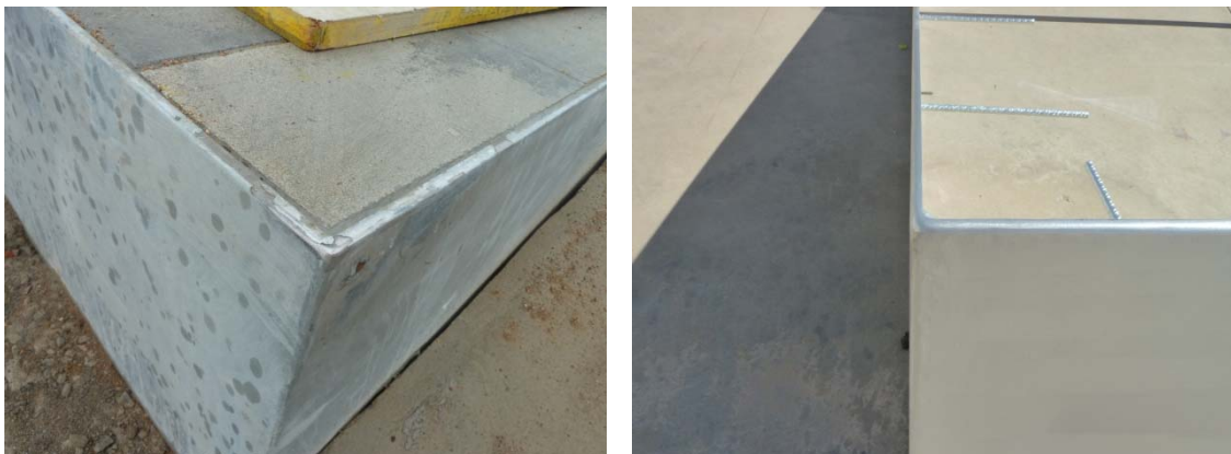
Arestes "arrodonides" a taller abans de galvanitzat, evitant punxes o fils que tallin, per platines i vores.
