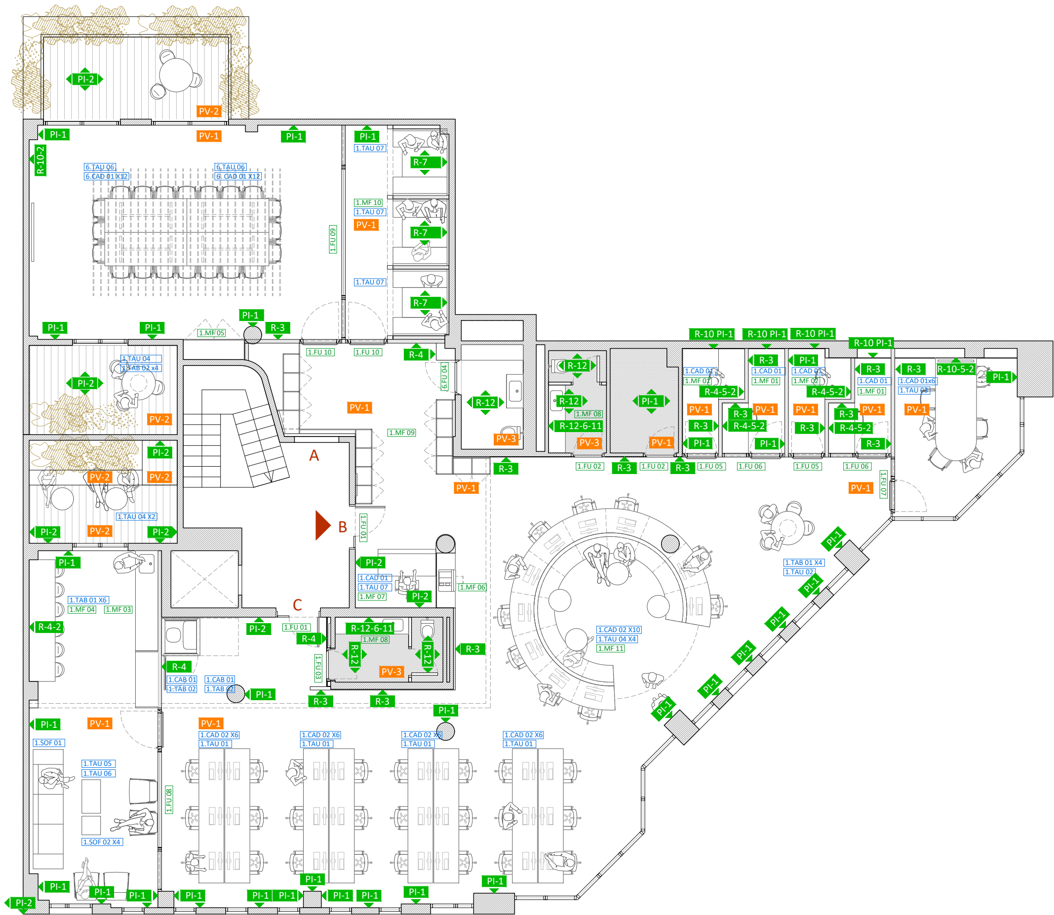
PRIMERA PLANTA. ACABATS GENERALS I INDICADORS FUSTERIA 1:100
