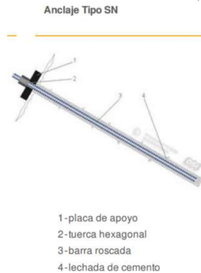
Figura 1: Esquema d'ancoratge Gewi tipus SN
