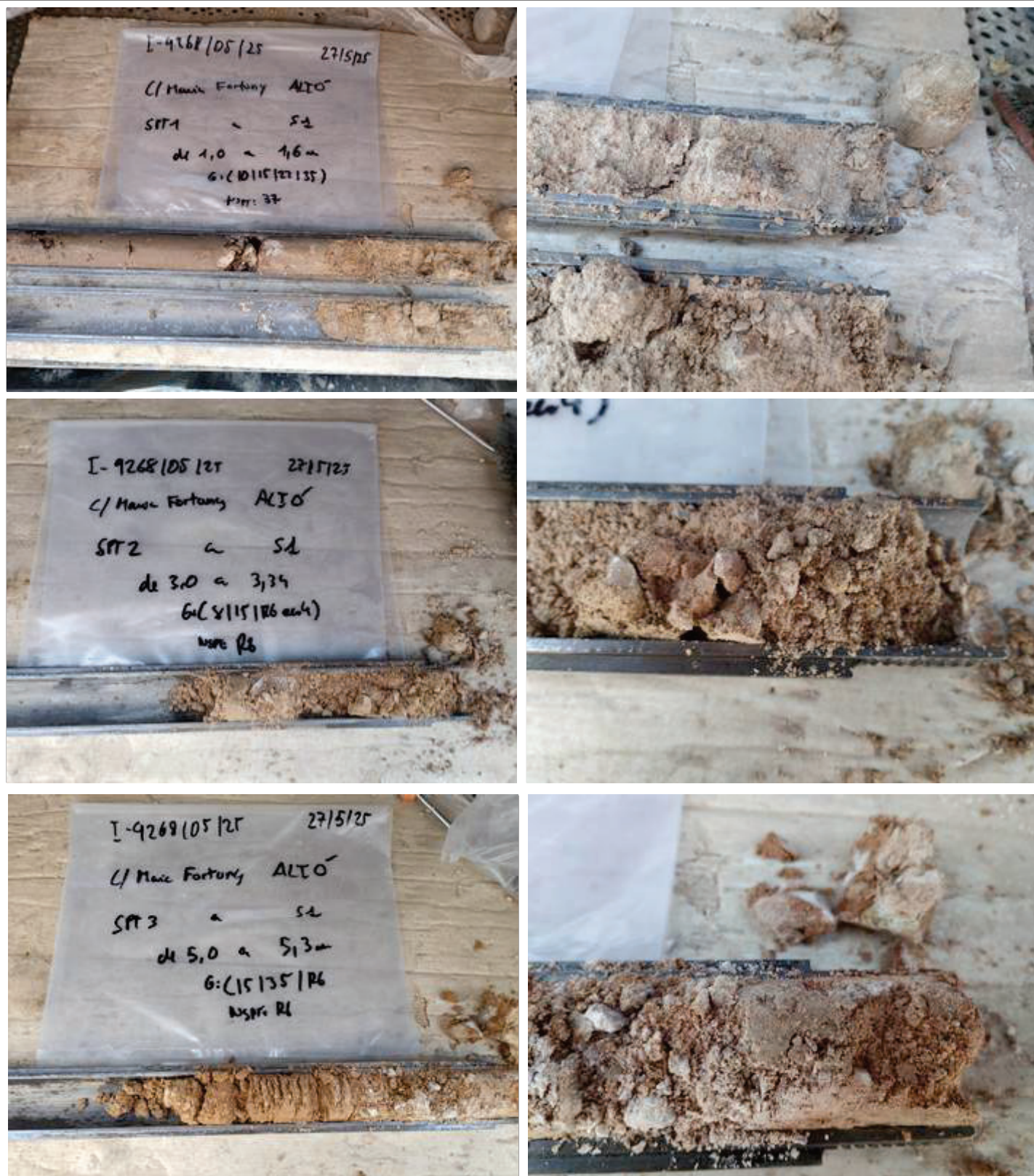
Vistes dels materials del subsòl extrets en tres assaigs SPT realitzats al llarg del sondeig S-1.
