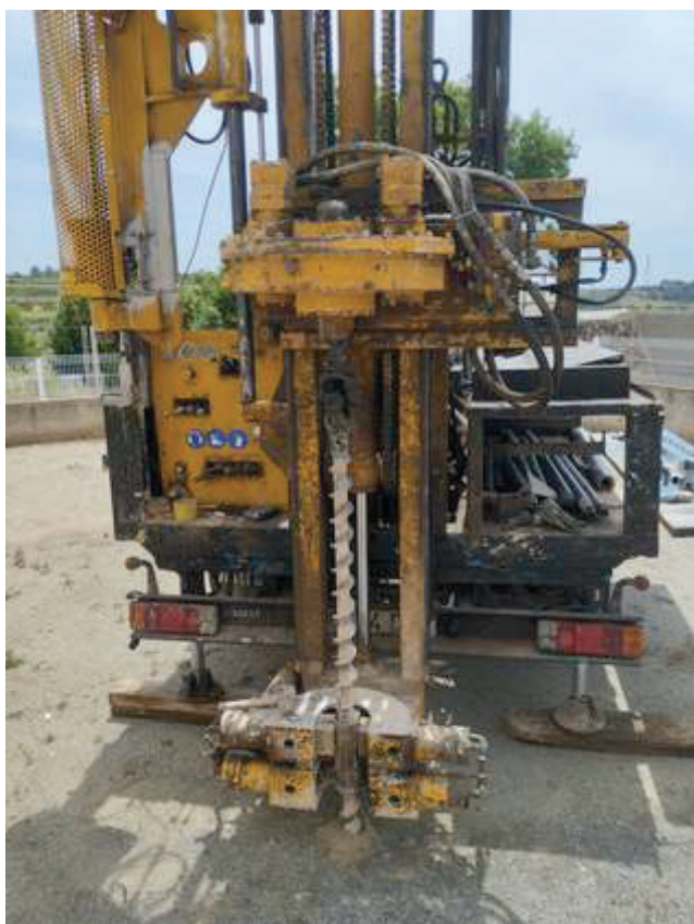
Vistes dels tres sondeigs realitzats a la zona objecte d'estudi, S-1, S-2 i S-3 del tipus rotació helicoïdal.
