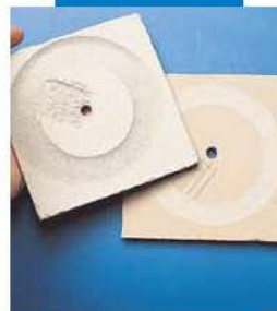
Abrasión Taber realizada sobre Ultraplan (derecha) y alisado convencional (izquierda) después de 200 vueltas
