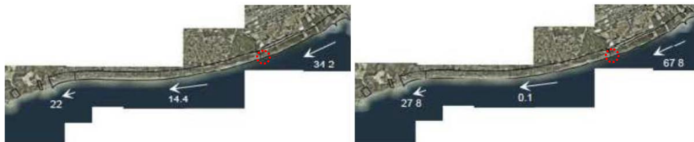
Figura 31.- Transporte longitudinal neto en la unidad fisiográfica en la que se encuentra la zona de estudio (que se indica con un círculo rojo) según el "Llibre verd de l'estat de la zona costanera a Catalunya"; Izquierda: fórmula de Kamphuis; derecha: fórmula del CERC. Fuente: CIIRC / Generalitat de Catalunya
