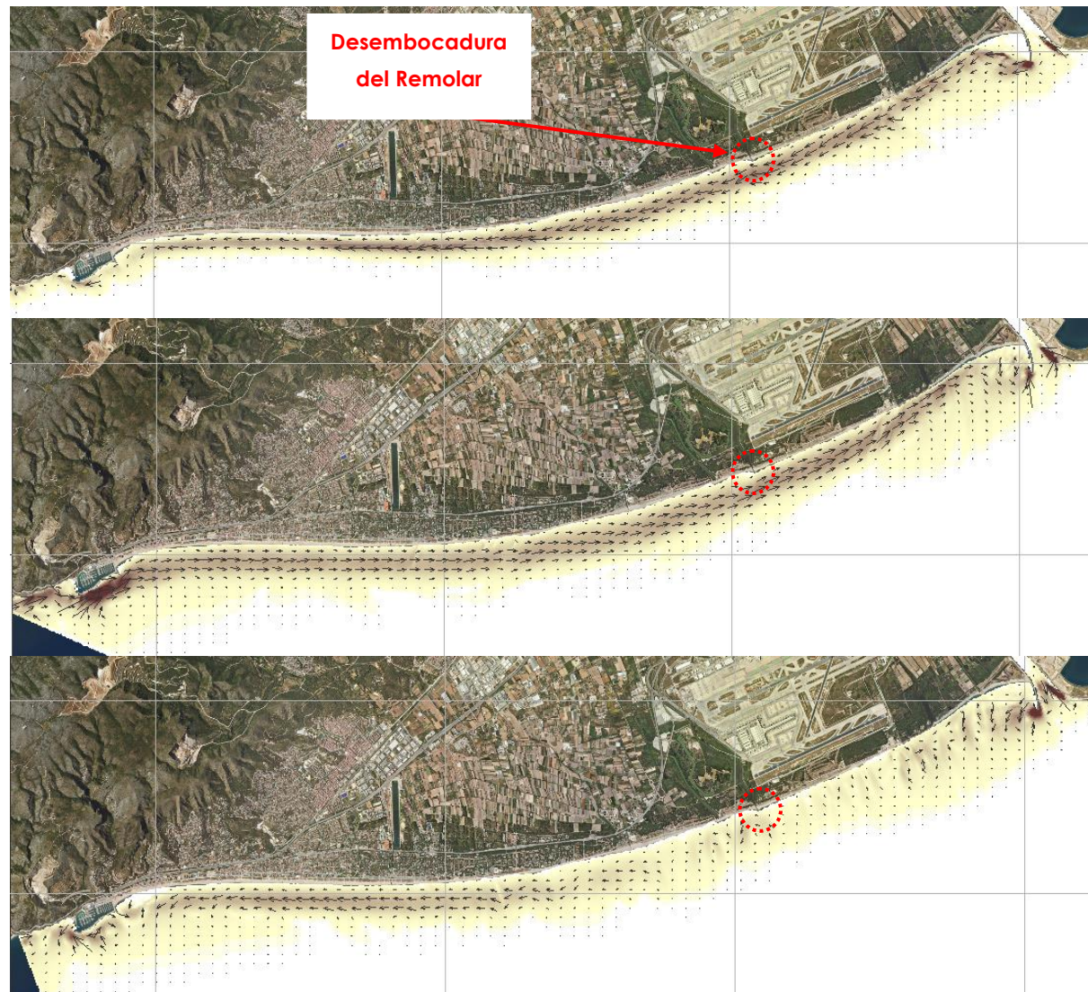
Figura 41.- Arriba: patrón con transporte de E a W en todo el tramo de costa (la ubicación de la desembocadura del Remolar se indica en rojo); en medio: patrón con transporte de W a E en todo el tramo de costa; abajo: patrón con transporte longitudinal y transversal (corrientes de retorno). Fuente: Marciglob
