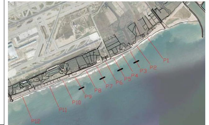
Figura 32.- Transporte longitudinal neto en la playa del Prat de Llobregat obtenido numéricamente. Fuente: Prointec / ATLL
